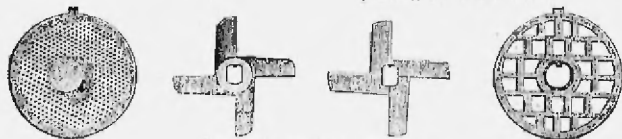
Внутренніе приборы мясорубки.
